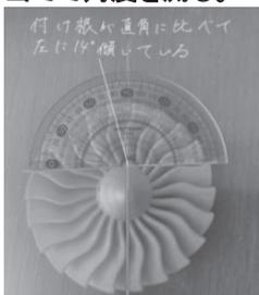
**実験2** 模型の羽の部分の角度を変えて、どれくらいの風が後ろに流れるのかということと比較する。
